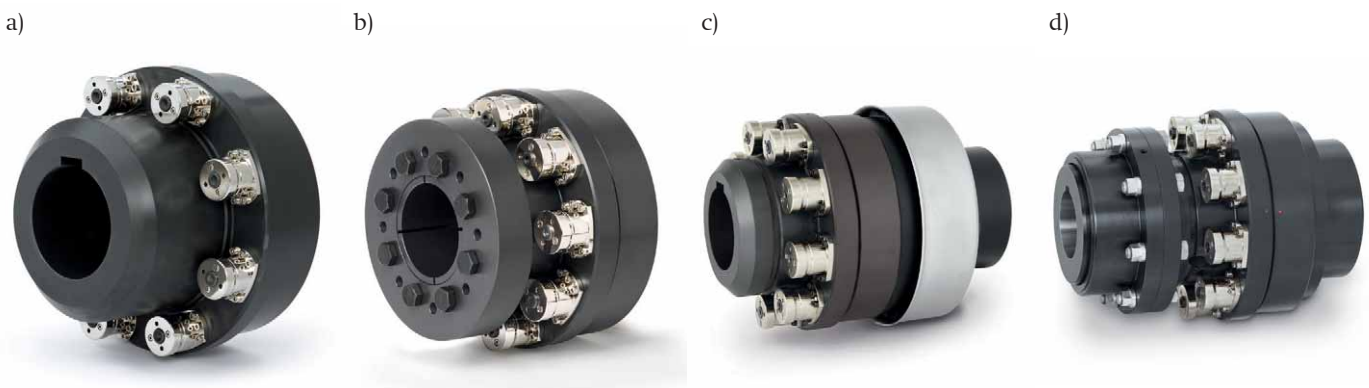
4 Die TORQSET-Kupplungen sind in verschiedenen Baugrößen erhältlich und modular aufgebaut: a) Modell ST1 für indirekte Antriebe mit Passfederverbindung, b) Modell STN für indirekte Antriebe mit Konusklemmverbindung, c) Modell ST2 für direkte Antriebe mit Passfederverbindung und elastischer Kupplung, d) Modell ST4 für direkte Antriebe mit Passfederverbindung und flexibler Zahnkupplung
