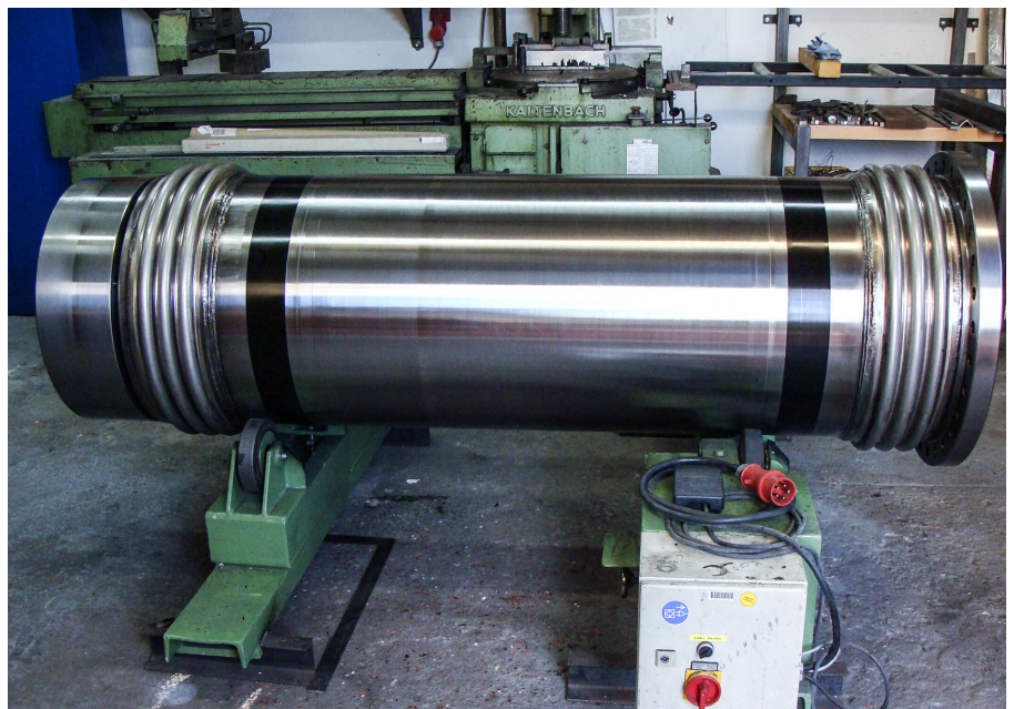
Bild 4 Die Auslegung des Metallbalgs erfolgte mit Hilfe der FEM-Analyse.
